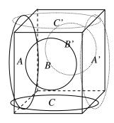
その上で、例えば面 A と A 上の対応する節点の x, y, z 方向の変位を以下の拘束方程式により拘束する。
