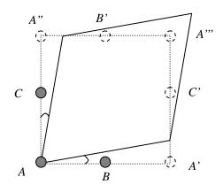
例えば、上の図のような二次元 8 節点のモデルの場合は、独立した節点は A,B,C の 3 つのみであり、他の節点は A,B,C のいずれかと関連付けられる。
