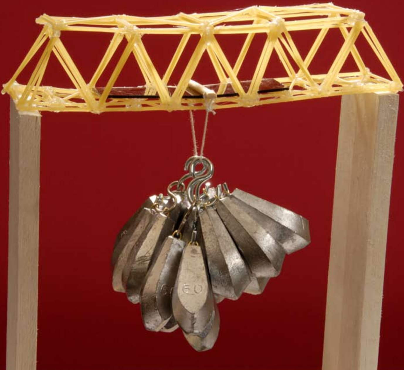
トラス構造の三角形は、橋にかかる力を分散させます。
