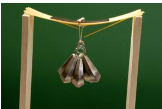
パスタ40本を束ねただけの橋は、2kgの荷重にも耐えられませんでした。
