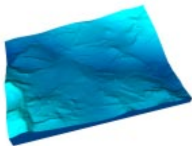
図 4.29: 観察倍率 1500 倍の脆性破面
