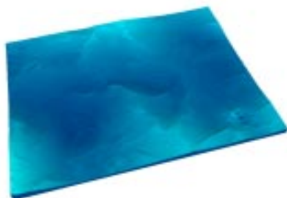
図 4.27: 観察倍率 1200 倍の脆性破面
