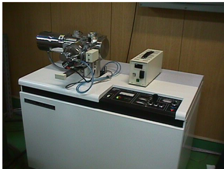
図 .5: イオンエッチング装置
