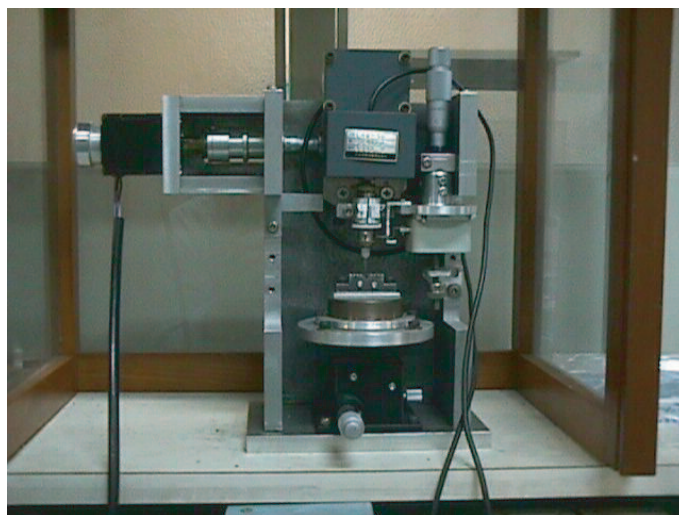
図 3.4: 3点曲げ破壊試験機
