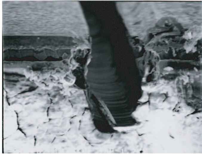
図 4.2: Ta マスクを用いて作成した溝構造
