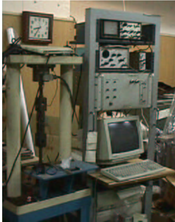
図 4.2: 疲労破壊試験に使用した試験機
