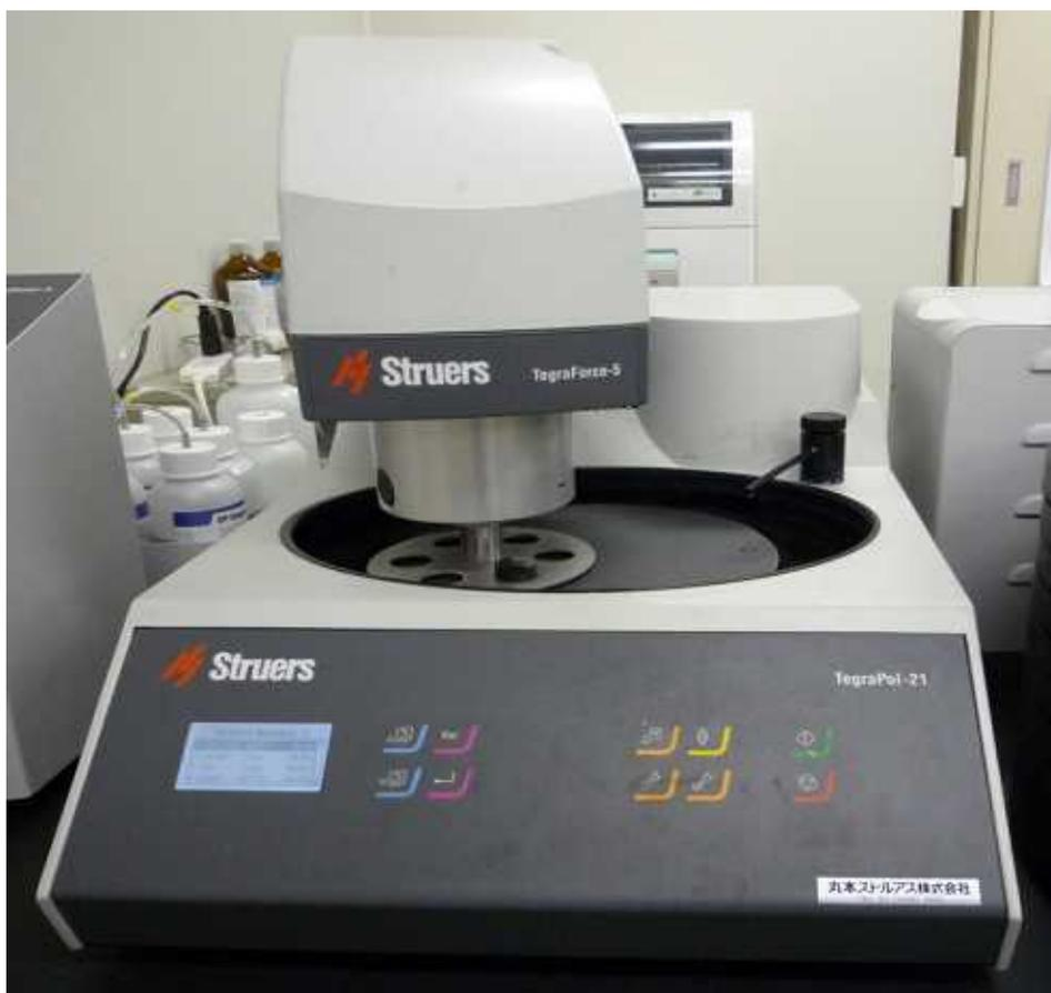
図 3-4 研磨試験装置
