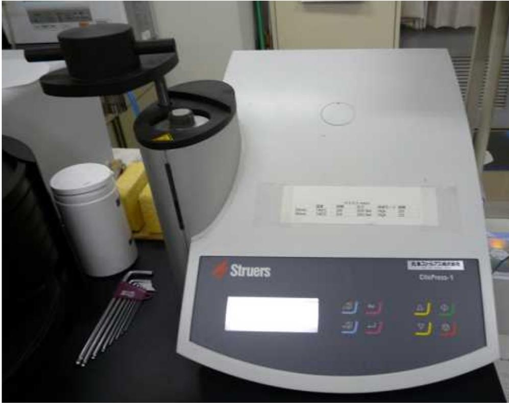
図 3-3 埋込試験装置
