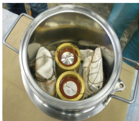
(d) Holding to 0.5 Torr with vacuum vessel
