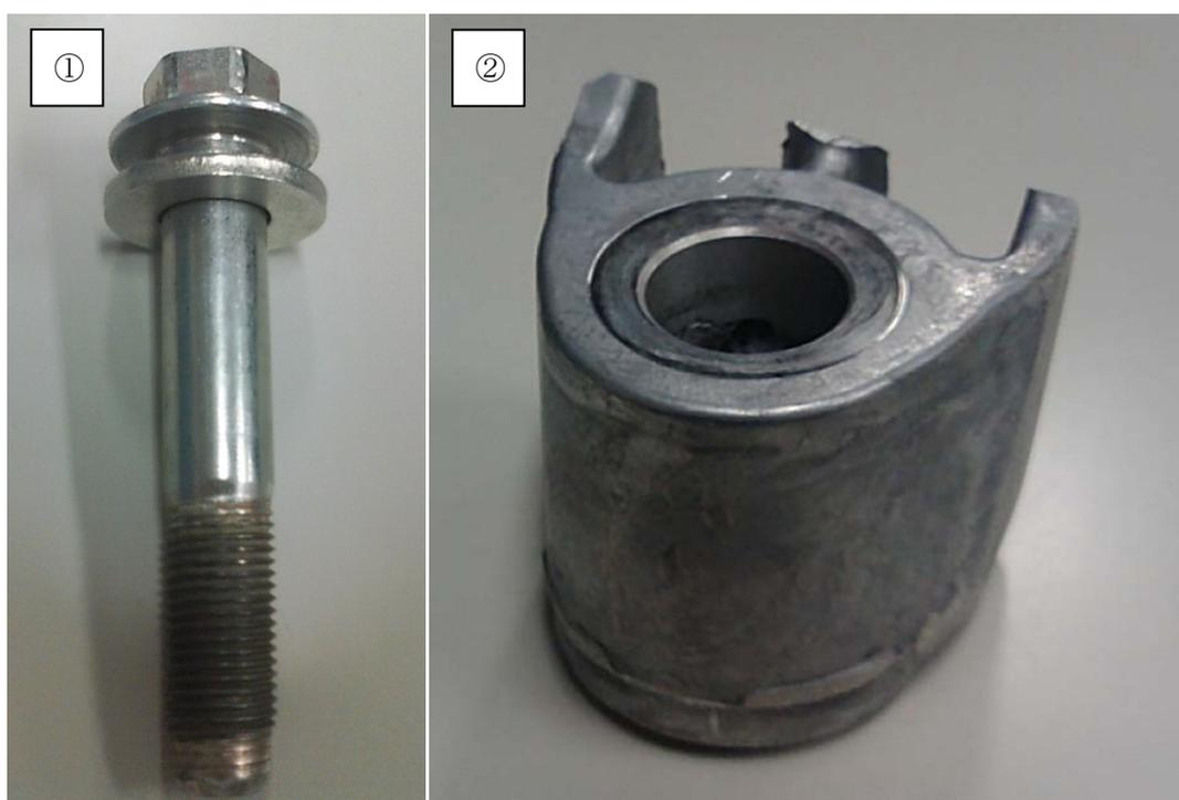
図 5.1 試料写真 (①：ボルト・ワッシャ，②：被締結体)
