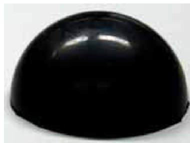
図 4-2 摩擦試験用ゴム試験片の写真
