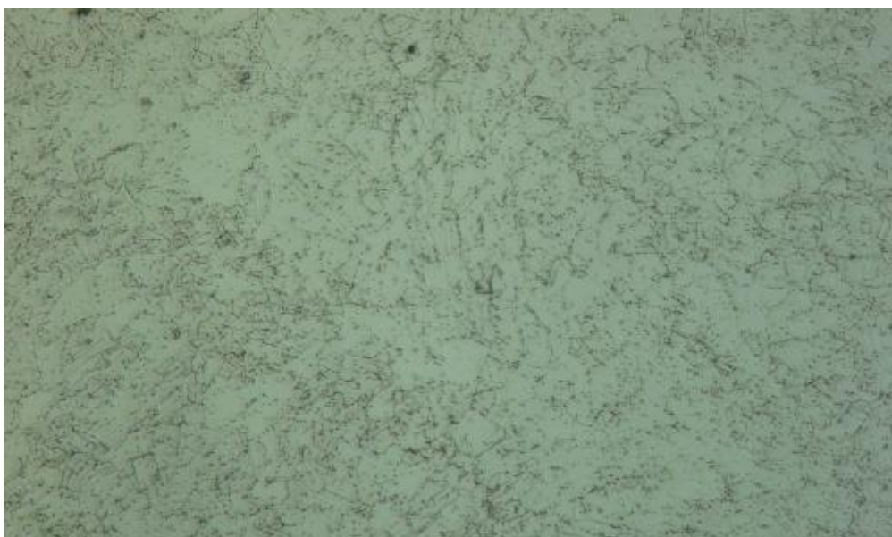
図 3-6 9Cr-1Mo 鋼 100%損傷材：溶金部
