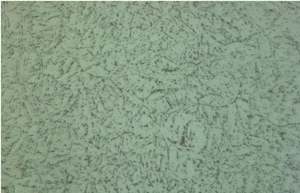
図 3-5 9Cr-1Mo 鋼 100%損傷材：母材
