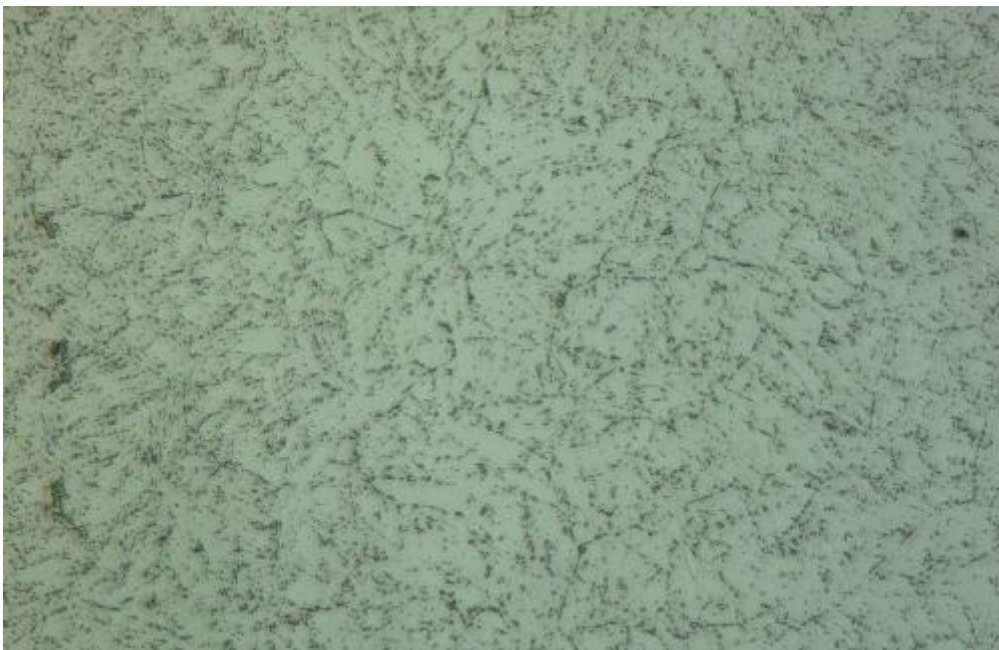
図 3-8 9Cr-1Mo 鋼 100%損傷材：粗粒部
