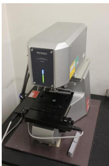
Fig. 3-2 レーザー顕微鏡.
