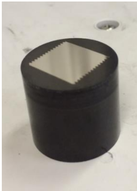
図 3.5 表面の研磨・琢磨を行った試料
