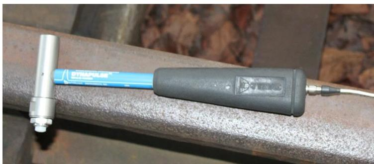
図 3.16 打撃試験 加振ハンマ
