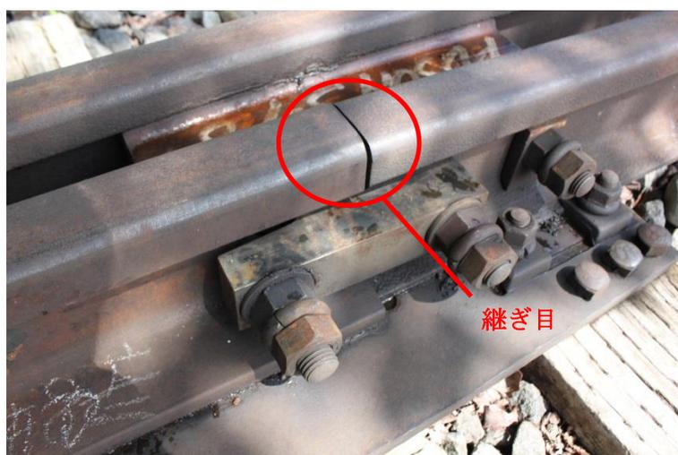
図 2.4 トングレール後端継ぎ目
