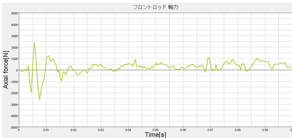
図 3.15 フロントロッド軸方向軸力 (C分岐器特急列車)
