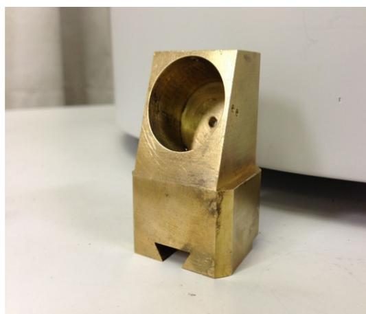
Fig.3-3 SEM 装置治具
