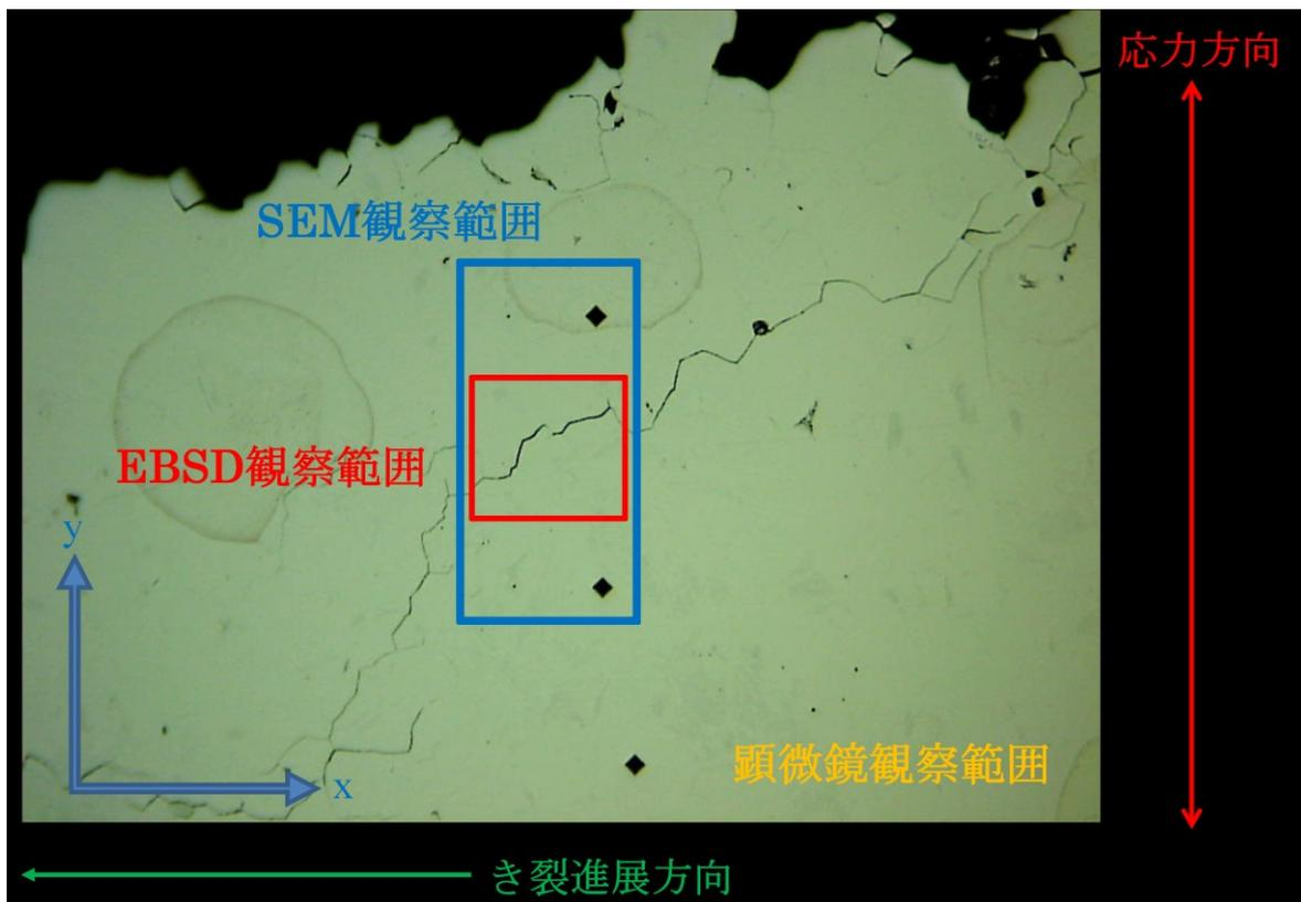
Fig.4-1 レーザ顕微鏡・SEM・EBSD 観察範囲例
