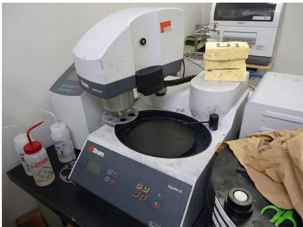
Fig.3-7 機械研磨装置
