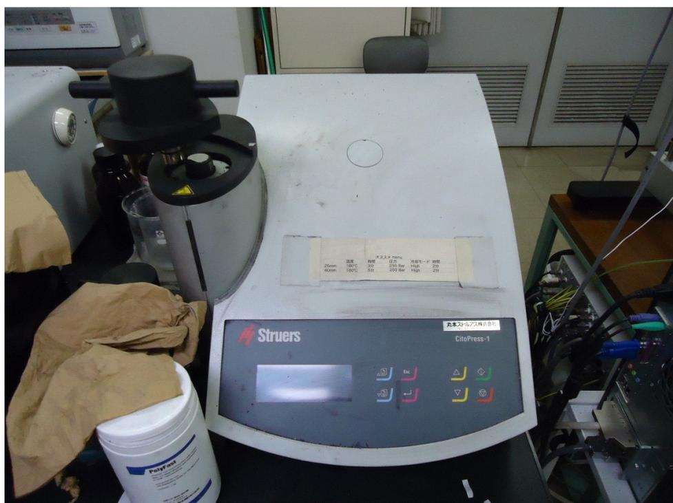
Fig.3-2 熱間埋込装置
