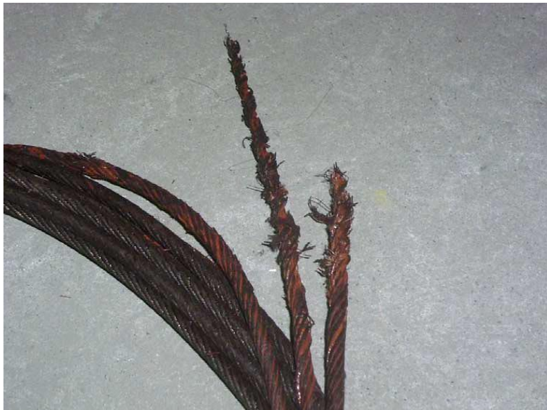
図 1.3 平和台駅エレベータ事故のロープ破断部． [2]
