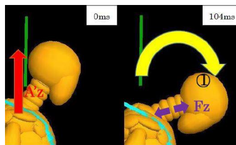
図 5-50 A'z が支配的な領域 B での頸部引張力
