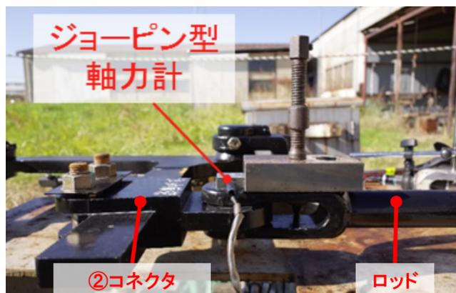
Fig. 3.10 ロッド軸力測定のための軸力計 [31]
