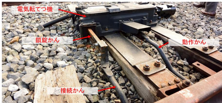
Fig. 2.10 電気転てつ機とその付属装置
