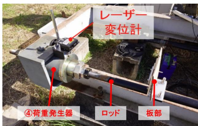
Fig. 3.9 ロッド変位測定のための変位計 [31]
