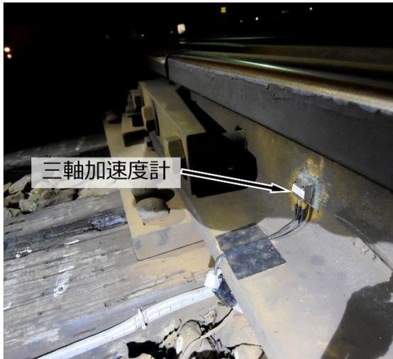
Fig. 4.3 トングレール後端部 測定機器
