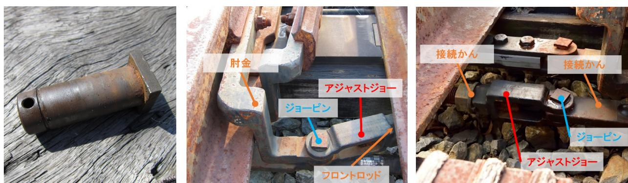
Fig. 3.2 (左)ジョーピン (中央)肘金部軸受 (右)接続かん間軸受
