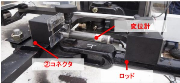
Fig. 3.11 ガタ量測定のための変位計 [29]
