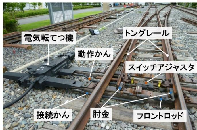
Fig. 2.3 転てつ装置全体図(普通分岐器)
