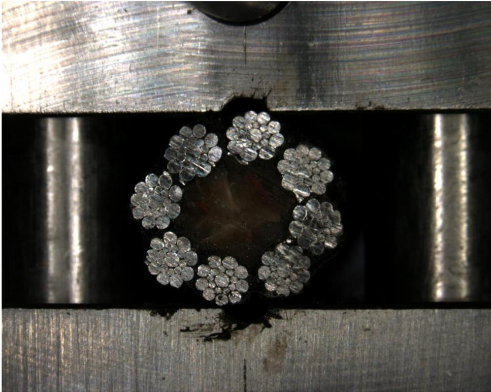
図 2-11 径方向荷重がかかっていないときのワイヤロープ断面の様子
