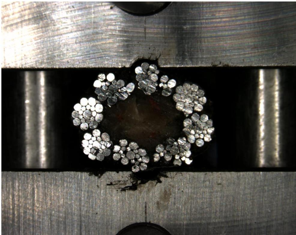
図 2-12 5kN の径方向荷重がかかったときのワイヤロープ断面の様子
