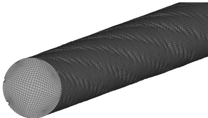
図 2-3 向井[25]の解析で用いられた心綱モデル
