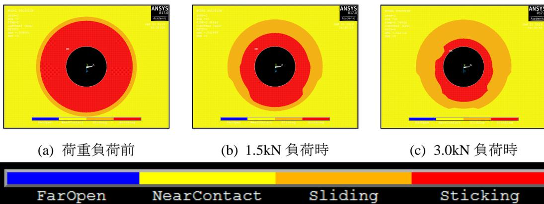
図 3-7 2枚目と3枚目の被締結体の接触面の接触状態
