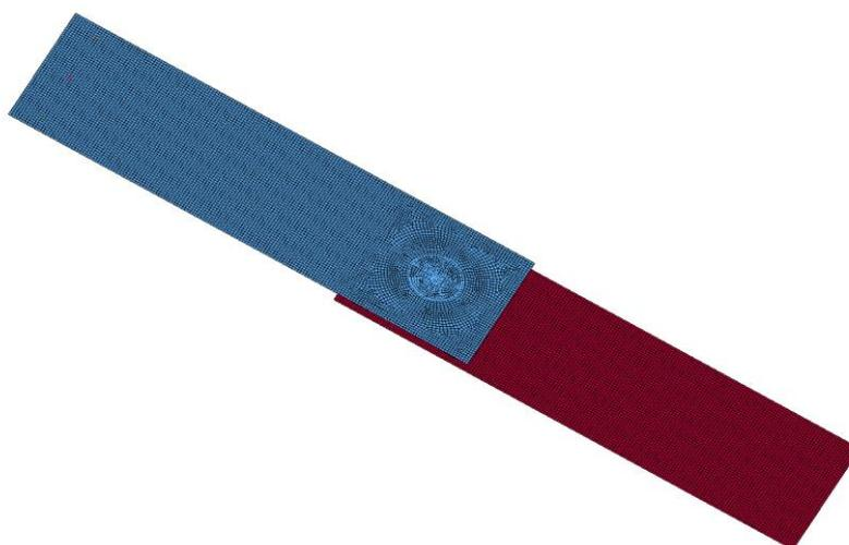
図 4-5 柳原の簡易モデル せん断継手（丸穴）
