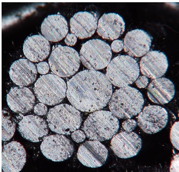
図 5-3 実際のストランド断面図（再掲）
