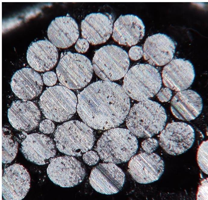
図 3-2 実際のストランド断面図
