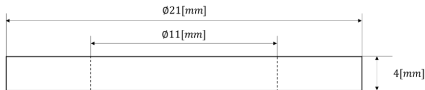
図 2-4 座金の形状及び寸法
