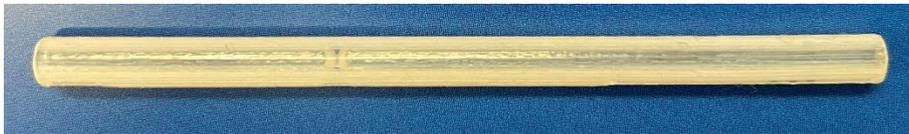
図 2-11 狭窄部内径  $150 \mu\text{m}$  の管（狭窄部は cos カーブ）
