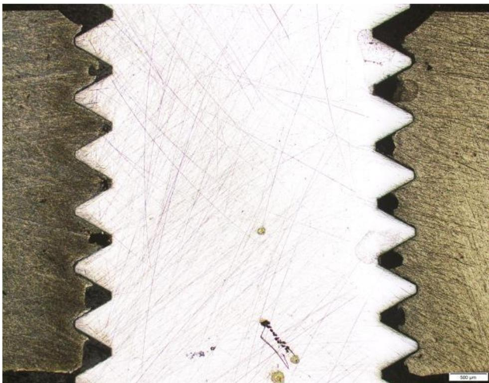
図 2-10 実機試験での雌ねじ成形形状 (タッピングねじ(3種)・下穴径φ4.6)
