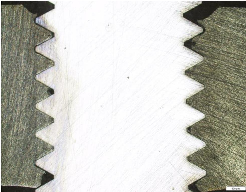
図 2-9 実機試験での雌ねじ成形形状 (タッピングねじ(3種)・下穴径φ4.4)
