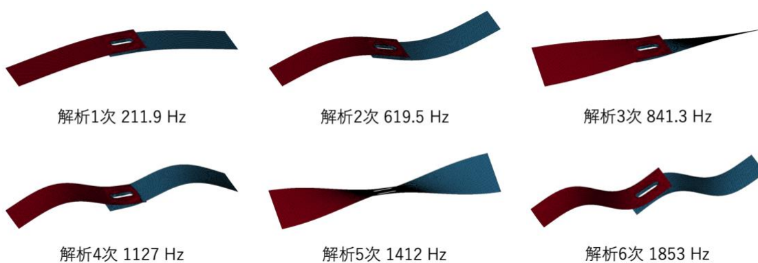
図 3-13 セン断継手（縦方向長穴） 解析 振動モード
