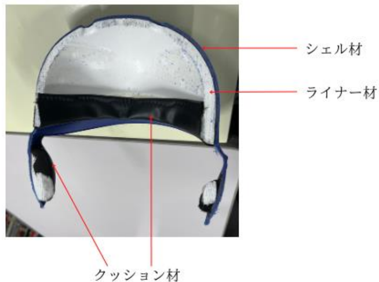
図 2-1 野球用ヘルメットの断面
