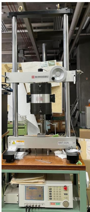
図 2-3 電磁式微小材料試験機
