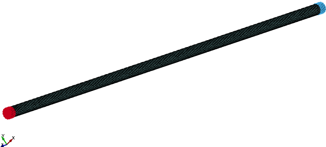
図 2-3 直 Fi(29)ストランドモデルの 3 次元メッシュ形状
