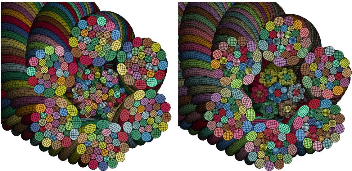
図 5-5 WS\_extent ロープモデルのメッシュ比較 (左) 低減モデル (右) 詳細モデル
