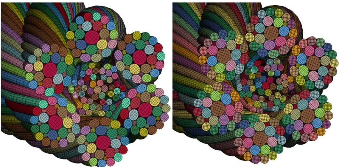
図 5-6 Fi\_extent ロープモデルのメッシュの比較 (左) 低減モデル (右) 詳細モデル
