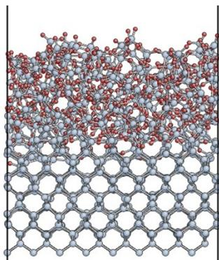
分子動力学によるシリコンの酸化シミュレーション
