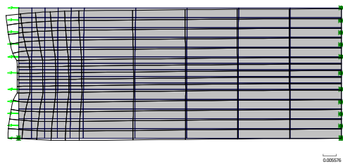
図 2 のモデルを分布荷重で引っ張った例
